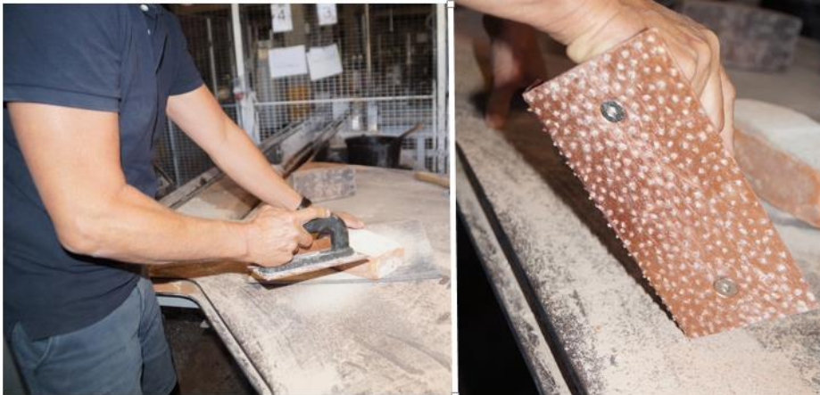
Foto 1: Rensning af mursten med Carbide Vinkel slibebræt, forsøg hos Gamle Mursten (Fotos Erik K. Lauritzen)
